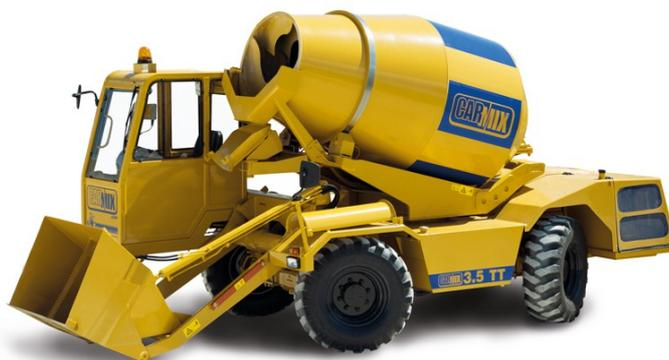
Возможность разгрузки готового бетона на 360 градусов вокруг и на высоту до 2 метров, компактность, высокая скорость выгрузки бетона, дополнительная система утепления кабины оператора, экономичный двигатель, удлиненный разгрузочный желоб.
